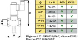
Mesures d'encombrement en mm Raccords filetés selon ISO 228/1 Corps laiton.
